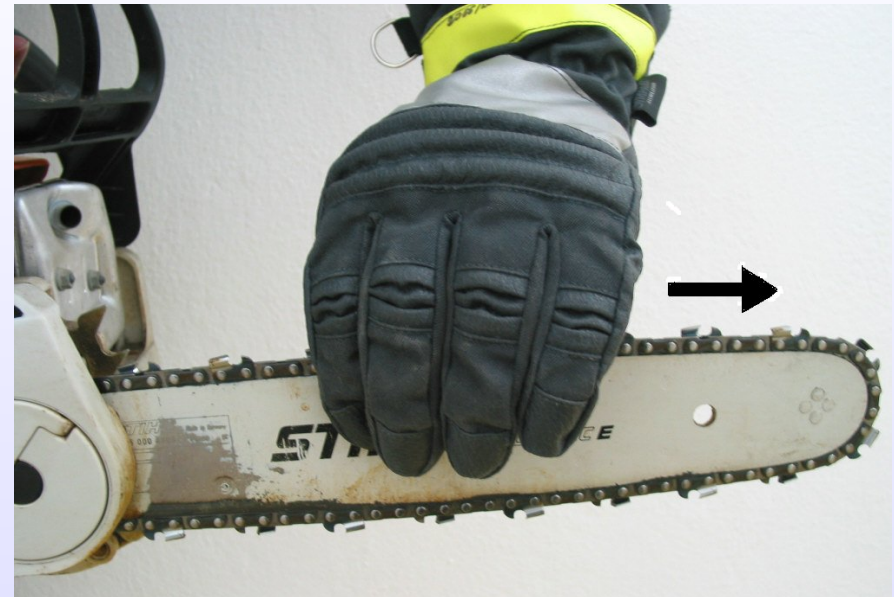
Sprawdzanie płynności ruchu łańcucha tnącego.
