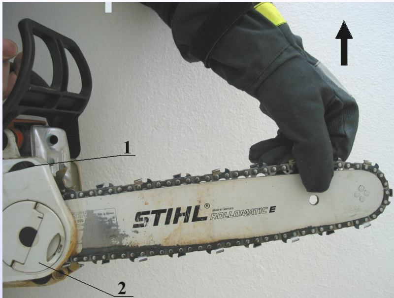
Prawidłowe napięcie łańcucha.
